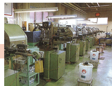
マルチフォーミングマシン 3次元の複雑形状対応可能 10万個/月以上生産
