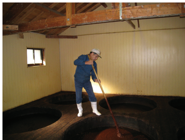
空気と触れ合う面積が微妙に計算された木桶
