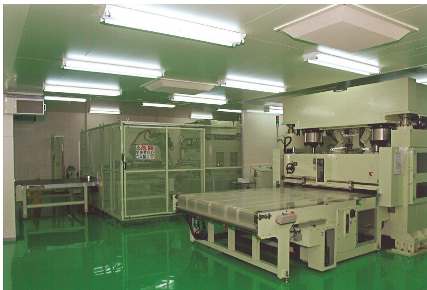
多関節ロボットと吸着ヘッドによる自動積載、 自動排出装置機能を持つ大型機
